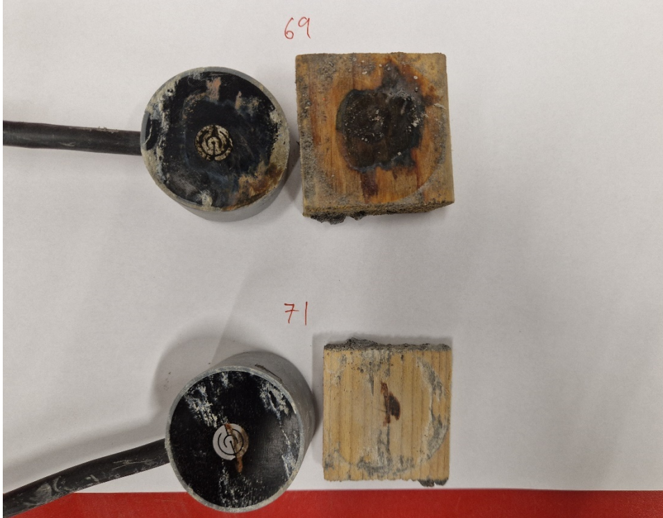
Figur 26: Visuell inspektion av ER-prob från försök 69 och försök 71.
