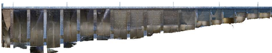
Figur 6-2: Skämklipp på sektion uppströms Damm 2 från skanning. Källa: Norconsult (2026)
