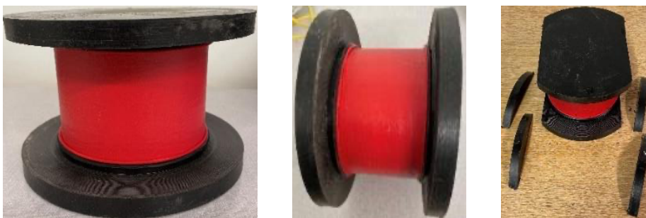
Figur 2 Fullt PE inkläst träcylinderprov som användes för att testa tätningseffektiviteten hos de undersökta tätningsmedlen; sidorna på ändskivorna kapades för att möjliggöra placering i väderometern (bilden till höger).
