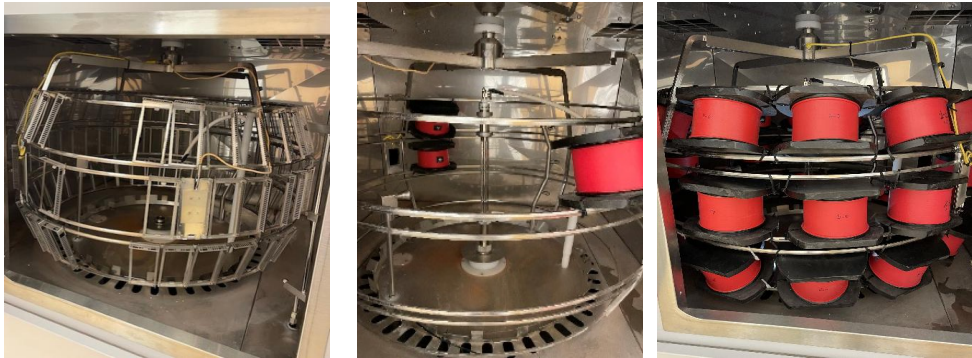
Figur 5 Roterande hållare i väderometer: tom, delvis lastad och fullt lastad konfiguration.
