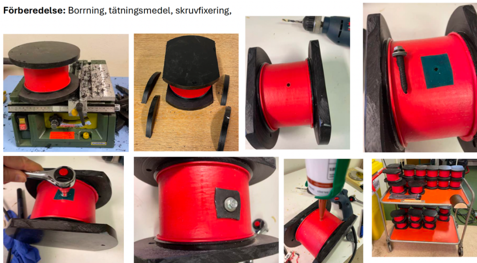
Figur 3 Borrning, applicering av tätningsmedel och inskruvning i PE inkapslade prov.
