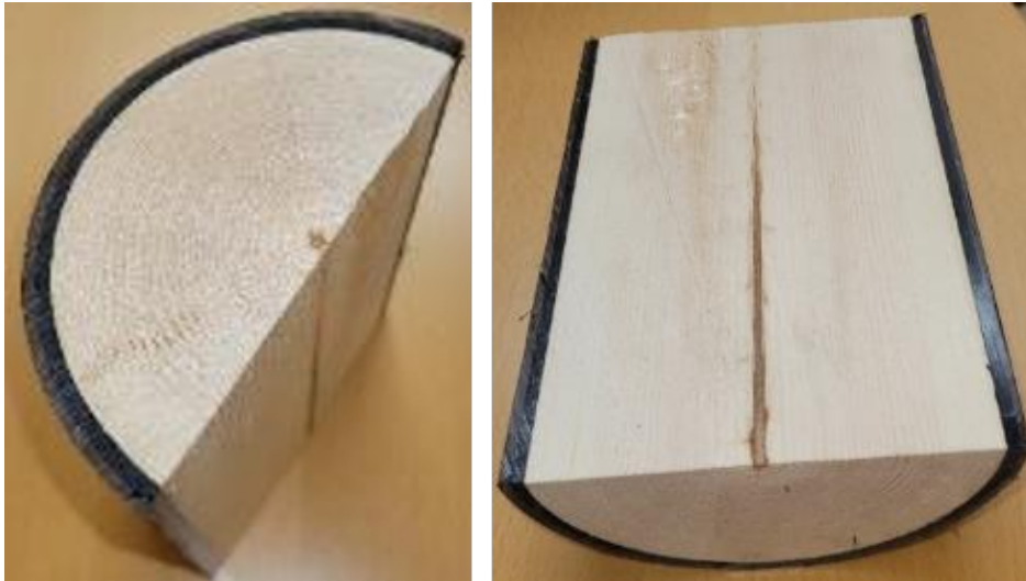
Figur 1 Delvis PE inkläst halvcylanderformat träprov som användes under initial metodutveckling.
