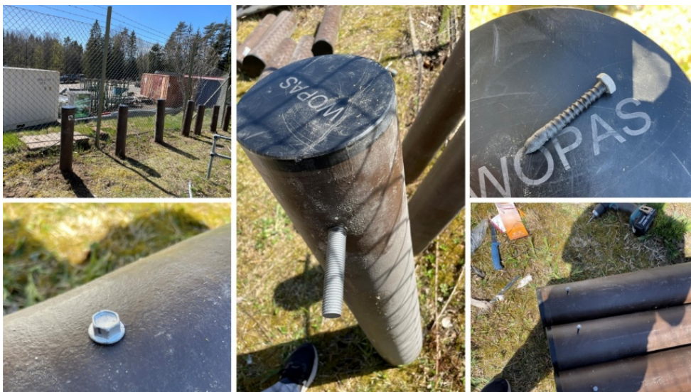
Figur 7 Slutlig uppställning av fältexponerade prover, med fästelement orienterade mot söder
