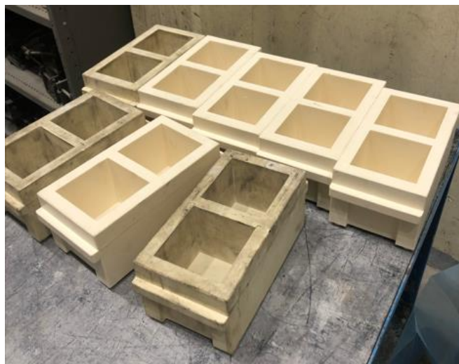
Figur 18. Formar för gjutning av betongprover.
