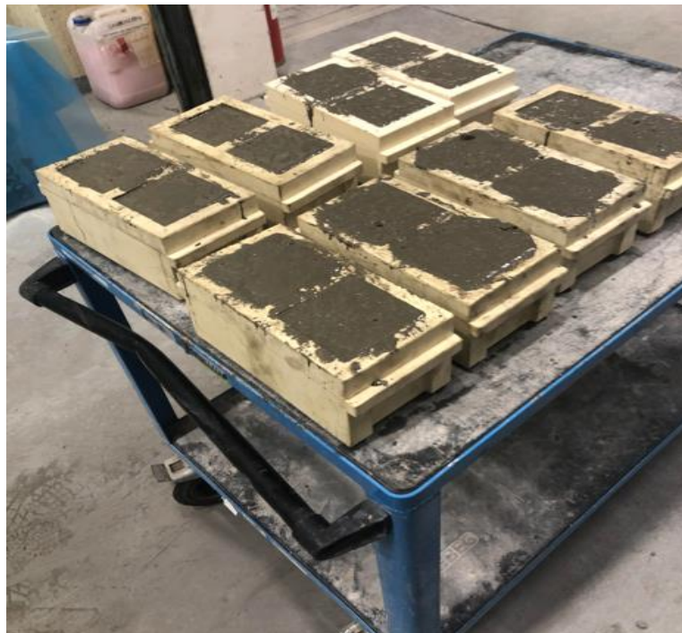
Figur 20. Formar med färsk betong.
