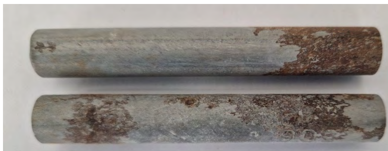
Figur 24L. Provtångernas utseende efter ca ett års utomhusexponering i reparationsbruk, Sto Crete TG3, Sto Skandinavien med insugna klorider.
