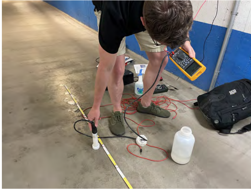
Figur 38. Kontrollmätning av skyddsförmågan hos ingjutna offeranoder av zink på både nyingjuten stålarmring och äldre befintlig ingjuten stålarmring.
