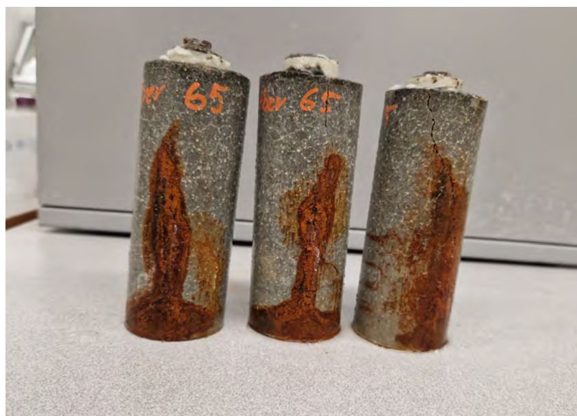
Figur 9b. Utseendet hos prover efter ca 50 dygns provning av Rep 65, Weber.
