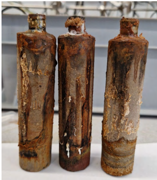
Figur 18. Oönskad korrosion orsakad av kloridtransport till gränsytan mellan stål i luft och betong.
