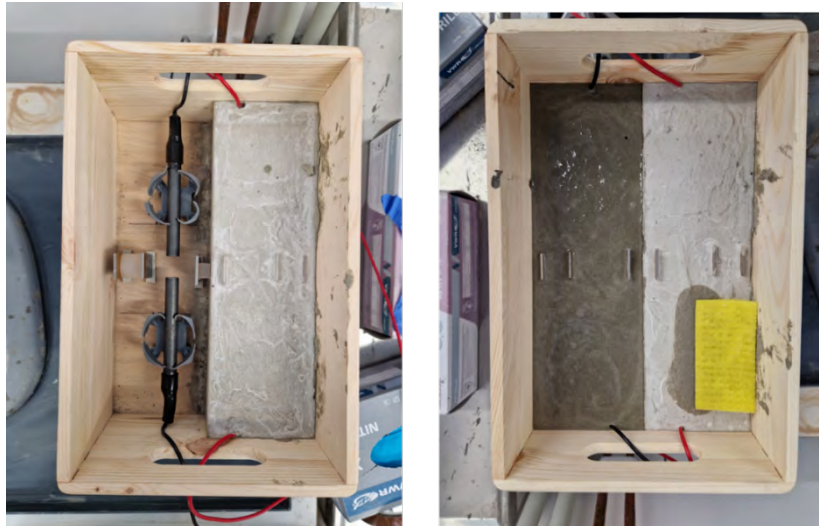
Figur 27. Probstänger som gjuts in i reparationsbruk utan klorider (vänster sida) och i en Veloxbetong med klorider (högersida). Röda pilar markerar delvis ingjutna provpaneler av rostfritt stål för mätning av betongens resistivitet.
