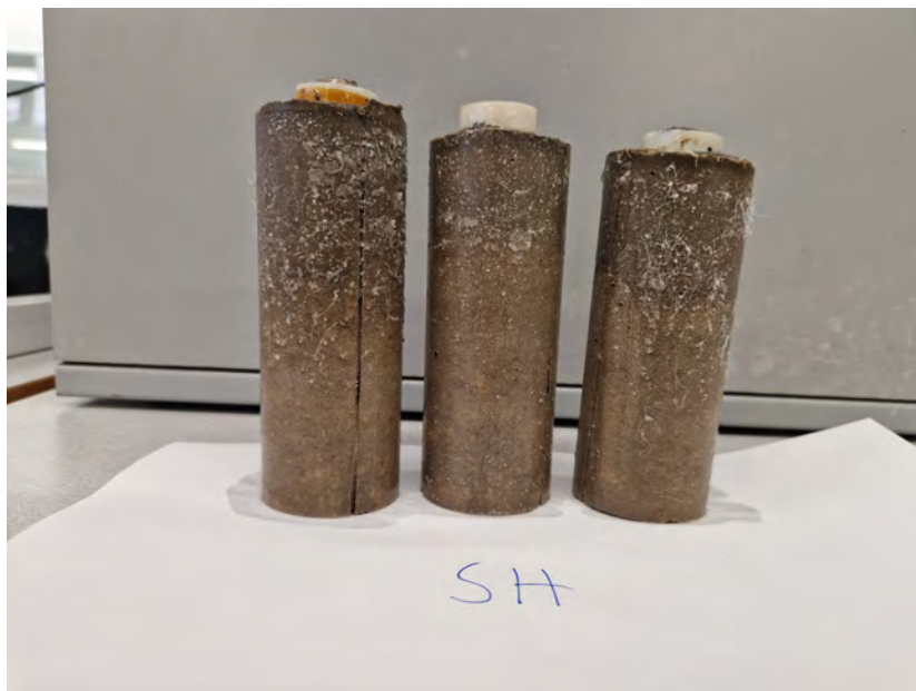
Figur 14b. Utseendet hos prover efter ca 50 dygns provning av Skövde SH (CEM I), hög C3A halt.
