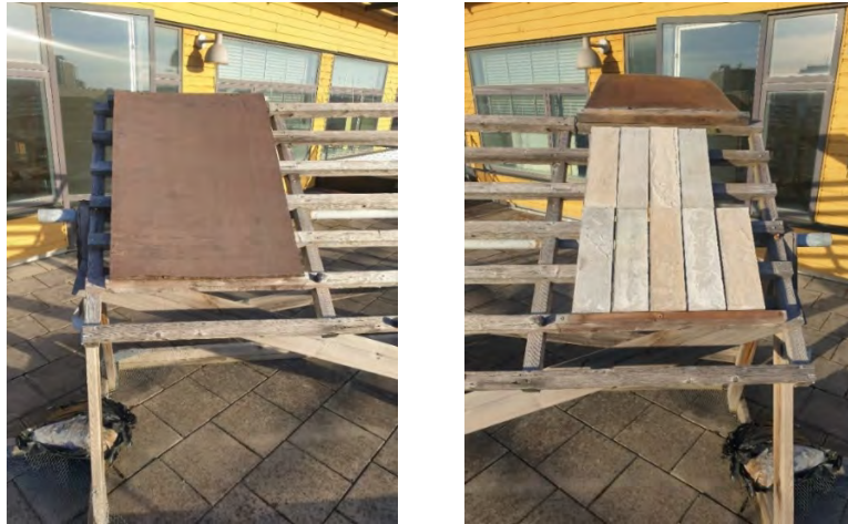
Figur 23. Fältexponering av betongprover vid RISE provningsstation i Kista där betongprover med olika bindemedel och ingjutna provstänger exponerades under ett regnskydd.
