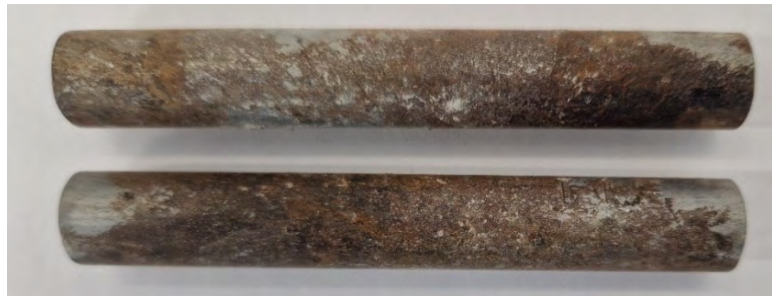
Figur 24F. Provstängernas utseende efter ca ett års utomhusexponering i reparationsbruk (Rep 65, Weber) med insugna klorider.
