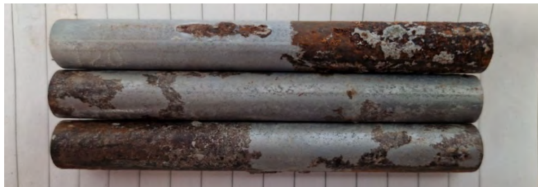
Figur 24S. Provstängernas utseende efter ca ett års utomhusexponering i referensbruk, Anl. FA, Slite, CEM II, Heidelberg) med ingjutna klorider.
