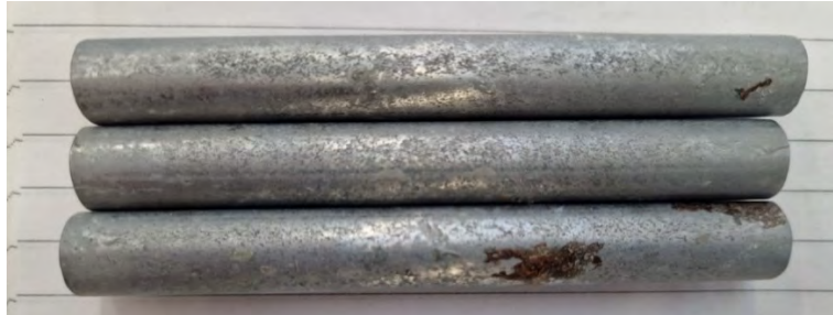
Figur 24A. Provtångernas utseende efter ca ett års utomhusexponering i reparationsbruk (MapegrouteT60, Mapei) med ingjutna klorider).
