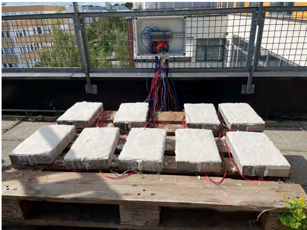
Figur 33. Provpställning för undersökning av zinknätanodens skyddande förmåga vid uppkomst av en galvanisk ström mellan korroderande provstänger och passiva provstänger.
