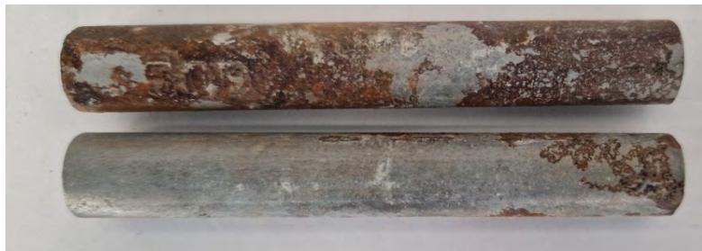
Figur 24J. Provtångernas utseende efter ca ett års utomhusexponering av reparationsbruk (Rep 931, Weber) med insugna klorider.
