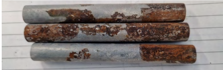
Figur 24Q. Provstängernas utseende efter ca ett års utomhusexponering i referensbruk, Anl. Slite, CEM I, Heidelberg) med ingjutna klorider.
