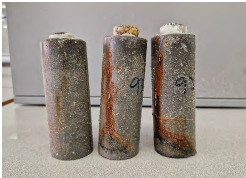
Figur 11b. Utseendet hos prover efter ca 50 dygns provning av Rep 931, Weber.
