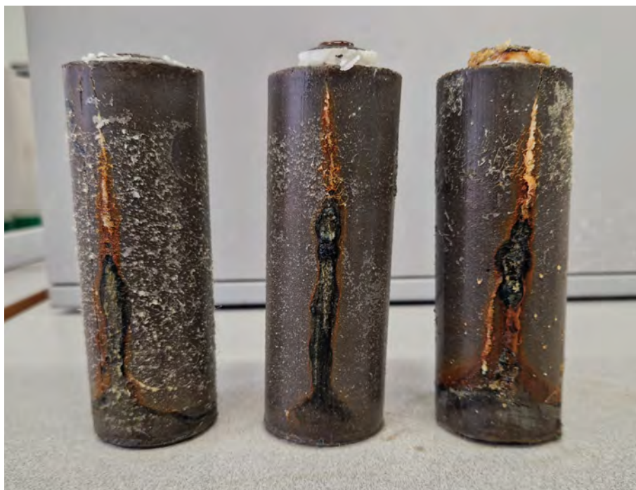
Figur 8b. Utseendet hos prover efter ca 50 dygns provning av Nonset 120 SR, Mapei.
