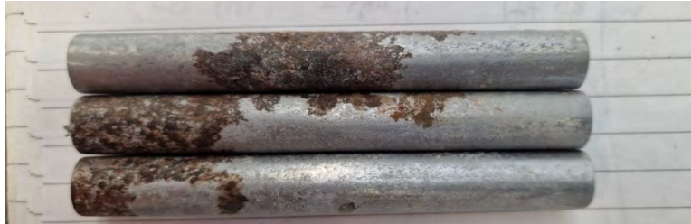
Figur 24E. Provstängernas utseende efter ca ett års utomhusexponering i reparationsbruk (Rep 65, Weber) med ingjutna klorider.
