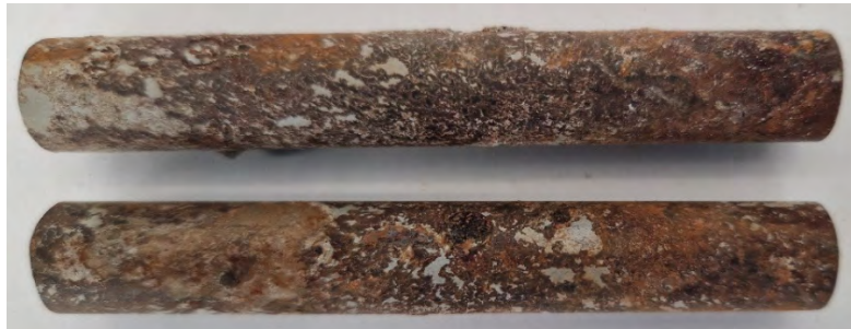
Figur 24R. Provstängernas utseende efter ca ett års utomhusexponering i referensbruk, Anl. Slite, CEM I, Heidelberg) med insugna klorider.
