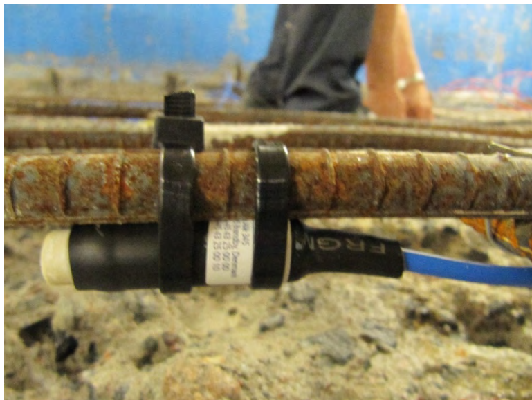
Figur 37. Monterad referenselektrod av typen MnO_2/Mn_2O_3 för bestämning av skyddsförmågan hos det katodiska skyddet.
