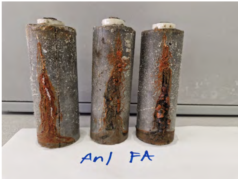
Figur 16b. Utseendet hos prover efter ca 50 dygns provning av Anl. FA Slite (CEM II/A-V), Heidelberg.
