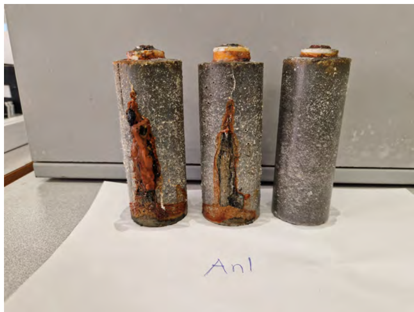
Figur 15b. Utseendet hos prover efter ca 50 dygns provning av Anl. Slite (CEM II/A-V), låg C 3 A halt, Heidelberg.
