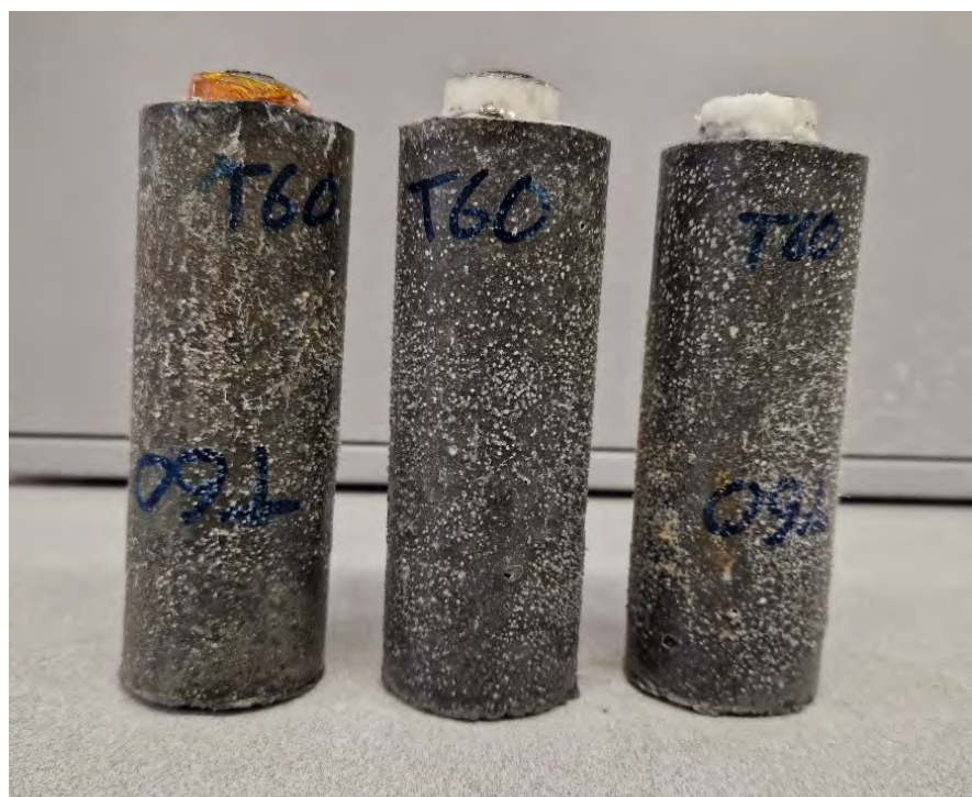
Figur 7b. Utseendet hos prover efter ca 50 dygns provning av Mapegroute T60, Mapei
