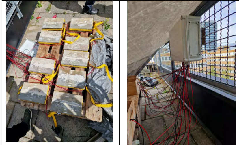
Figur 28. Provblock med ingjutna provstänger med mätkablar för mätning av galvanisk ström (makrocellström). I hopkoppling av provstänger sker via plintar i mätskåpet.
