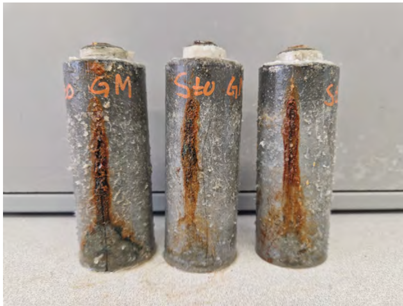
Figur 13b. Utseendet hos prover efter ca 50 dygns provning av Sto Crete GM, Sto Scandinavien,
