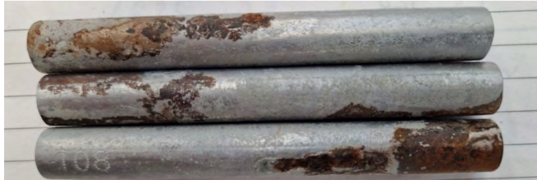
Figur 24M. Provtängernas utseende efter ca ett års utomhusexponering i reparationsbruk (Sto Crete GM, Sto Skandinavien) med ingjutna klorider.
