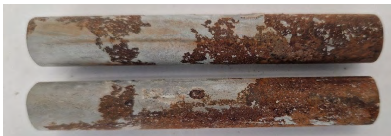
Figur 24P. Provtängernas utseende efter ca ett års utomhusexponering i referensbruk, Skövde SH, CEM I, Heidelberg, med insugna klorider.
