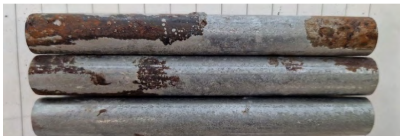
Figur 24K. Provtångernas utseende efter ca ett års utomhusexponering i reparationsbruk, Sto Crete TG3, Sto Skandinavien med ingjutna klorider.
