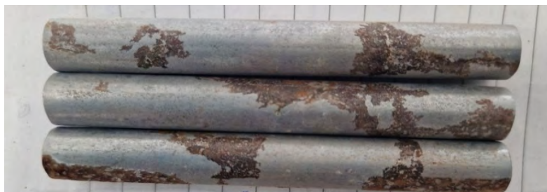
Figur 24O. Provtängernas utseende efter ca ett års utomhusexponering i referensbruk, Skövde SH, CEM I, Heidelberg), med ingjutna klorider.
