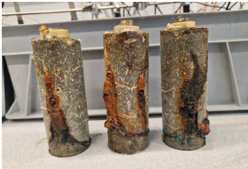
Figur 10b. Utseendet hos prover efter ca 50 dygns provning av Slamma+Rep 65, Weber.
