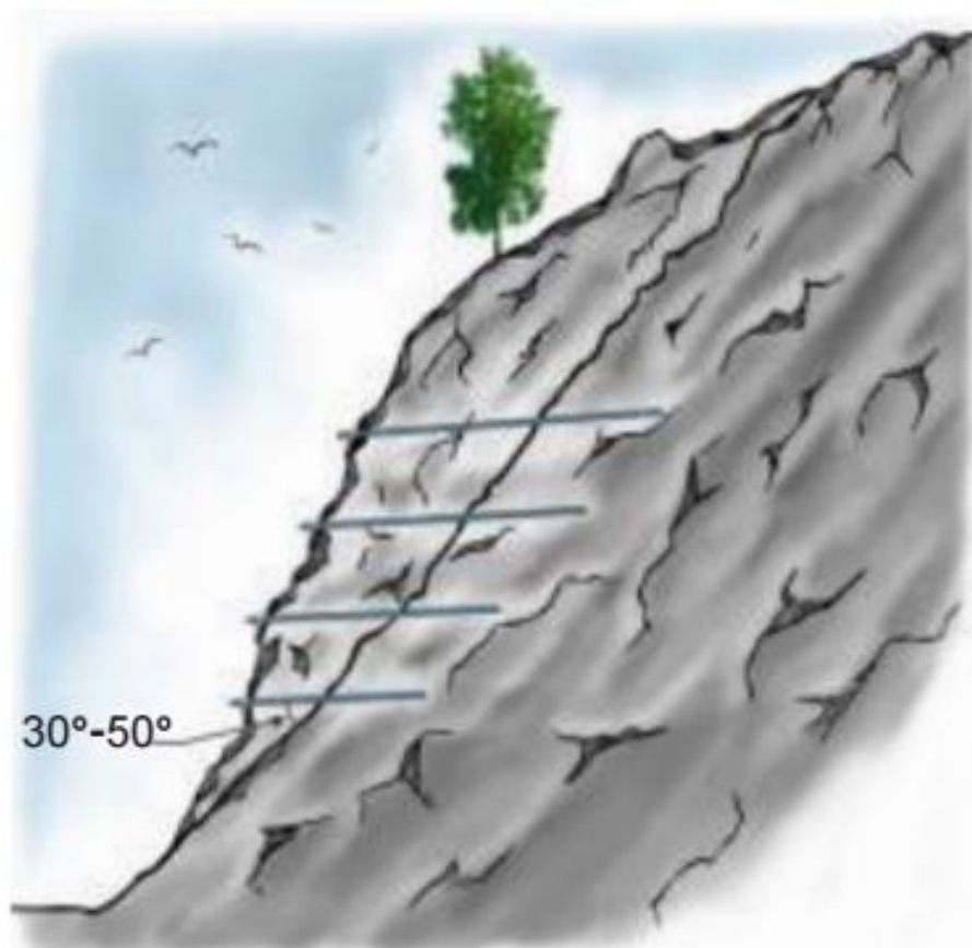
Figur 3 Föreslagna vinklar bult i slänt med sprickplan 74 .
