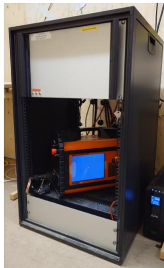
Figur 40. Mätssystem för ERT / DCIP som användes för långtidsövervakning i testdammen i Älvkarleby.
