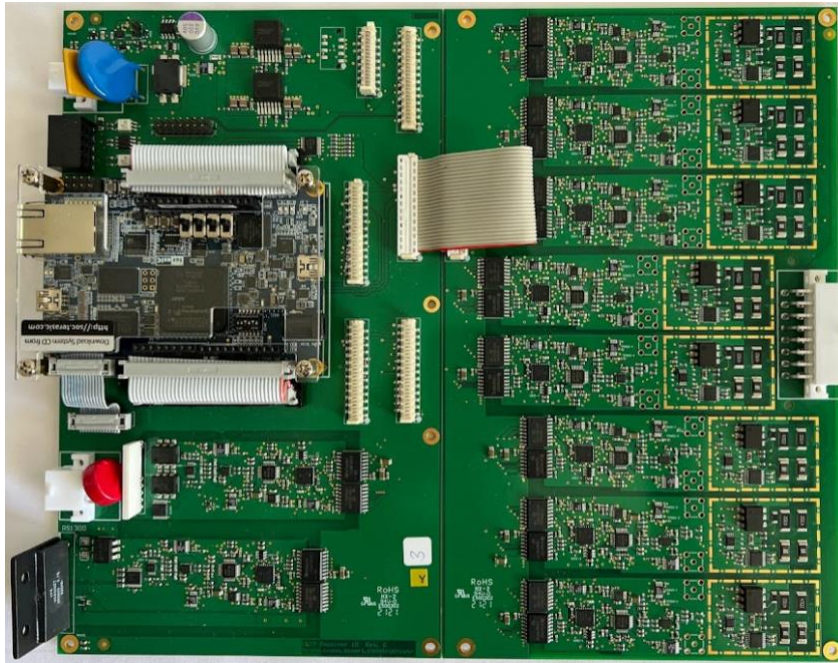
Figur 44. Ingångsprototypkort med 8 ingångskanaler, plus två mätkanaler för mätning av ström och spänning för sändaren, samt datormodul med FPGA och ARM-processor.
