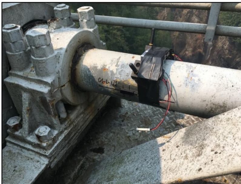
Figur 17. Trådtöjningsgivare för mätning av skjuvning monterade på axel för att utvärdera vridande moment, fotografi från Bridge Diagnostics, Inc. (BDI).
