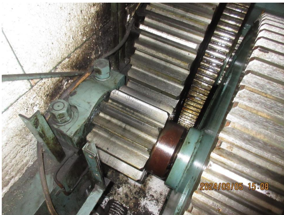
Figur 5. Exempel på kugghjul i en öppen växel.
