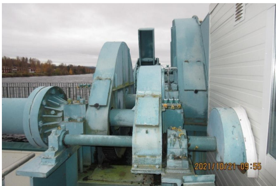
Figur 4. Exempel på kuggstångspel med öppen växellåda och momentöverförande axel.
