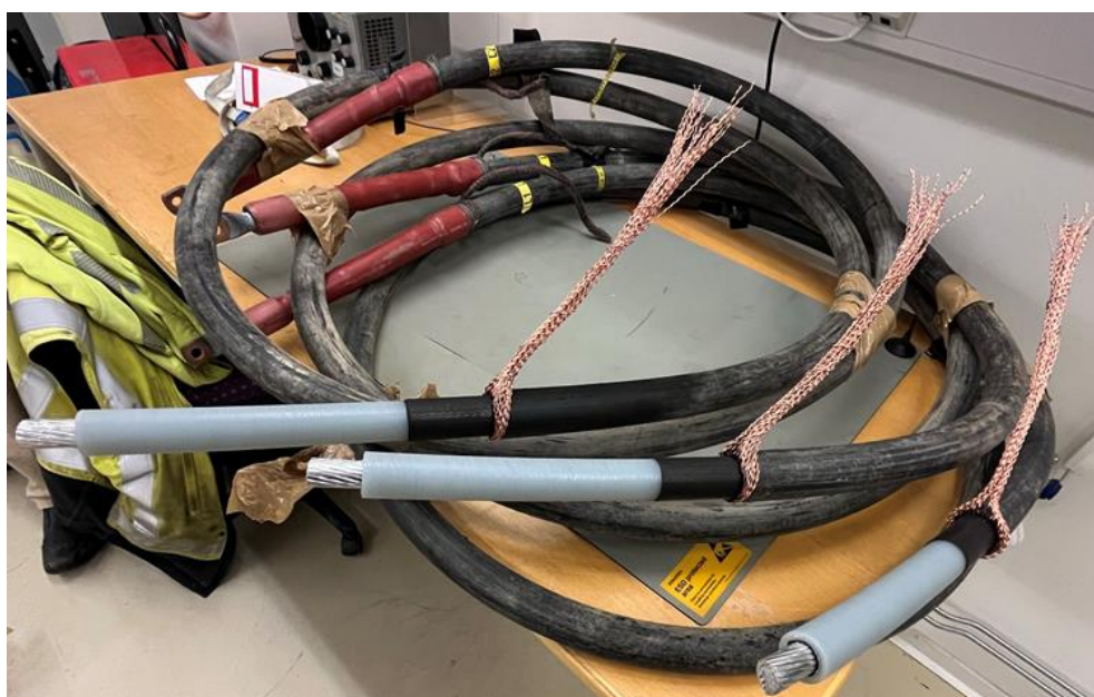
Figur 14. Tre enledaravslut förberedda för prov.
