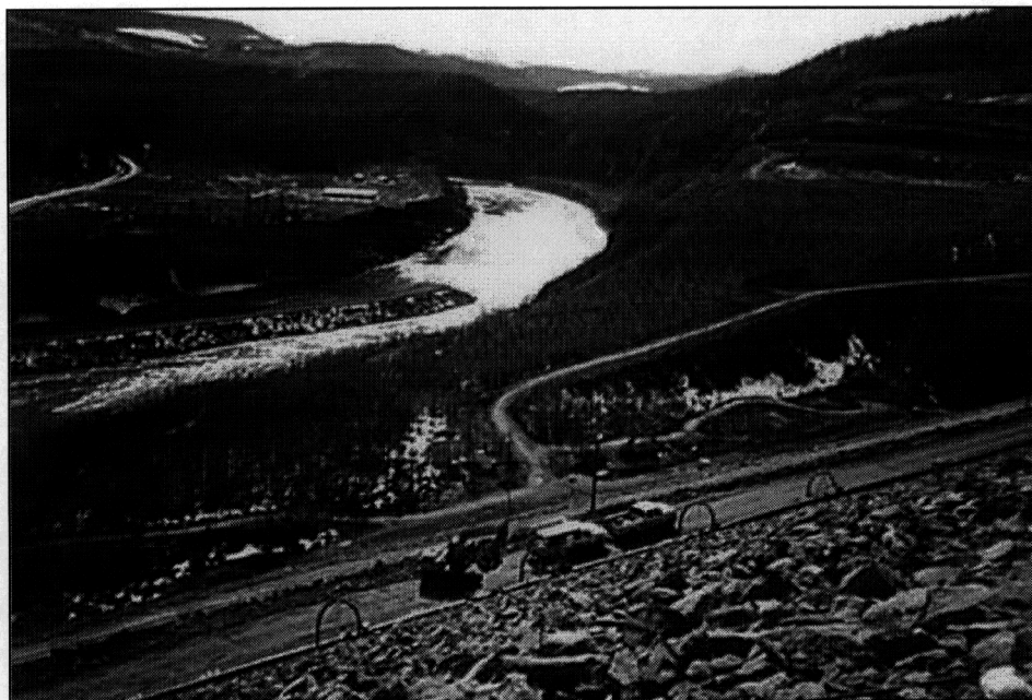
Figur 7 Ledning för infiltrationsförsöket på terassen, där fyra brunnar var inkopplade, jfr de fyra byglarna av flexibla ledningar.
