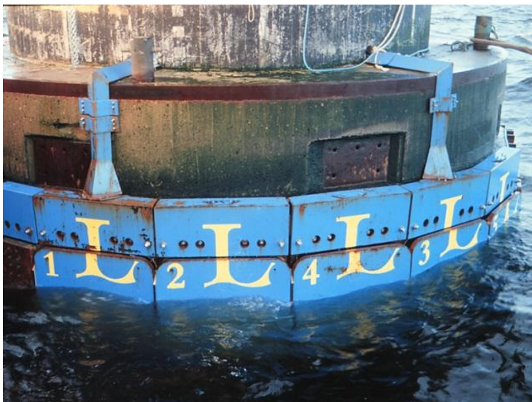
Figur 2.2 Paneler för fullskalemätning av islast mot fyren vid Norströmsgrund (Foto: Lennart Fransson, LTU).
